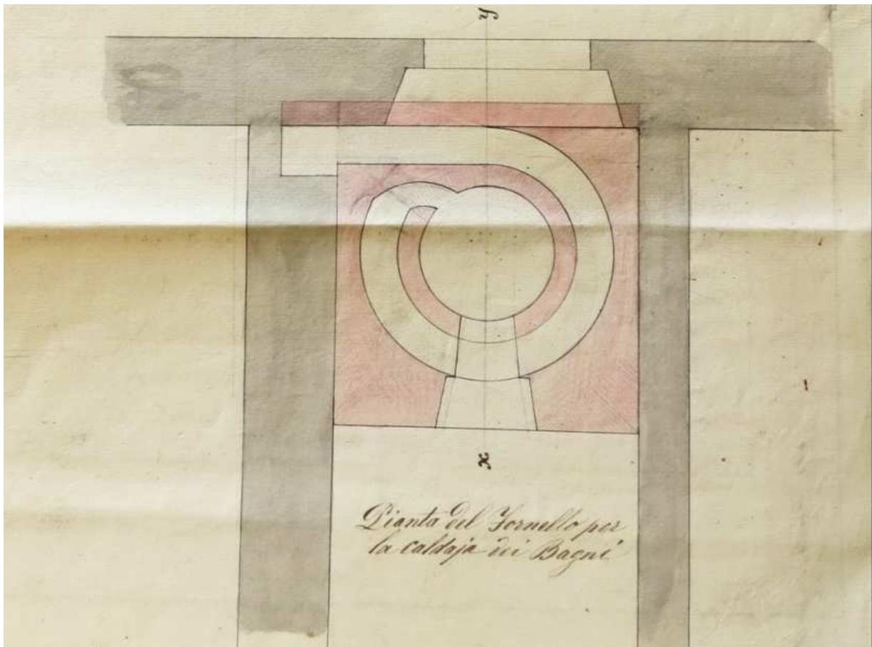
Fig. 41. 1849 - Progetto dell'ing. Angelo Brambilla del fornello per la caldaia dei bagni per pellagrosi
