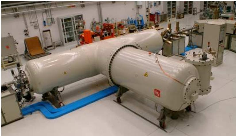
Fig. 5. Il blocco centrale dell'acceleratore di particelle all'interno del laboratorio del LABEC
